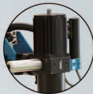
攻丝正、反转控制按钮 兼具停止功能
